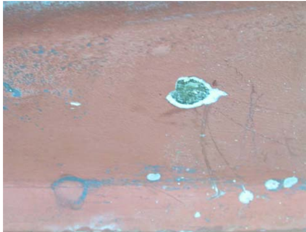
Consecuencia última que causa en el gelcoat la ampolla osmótica
